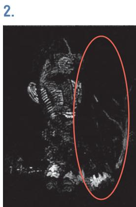
La cartographie du mercure permet de distinguer un arbre (tronc et branches) dans la partie droite de la composition.
